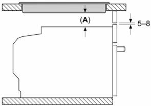
A: 燃气灶底部和烤箱顶部之间的最小距离: 55 mm (仅适用于 BSH 燃气灶)
