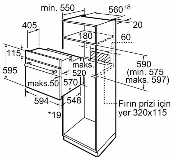
\* Metal ön cephe için 20 mm
