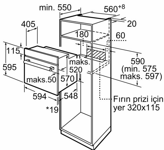
\* Metal ön cephe için 20 mm
