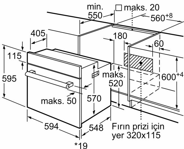
\* Metal ön cephe için 20 mm
