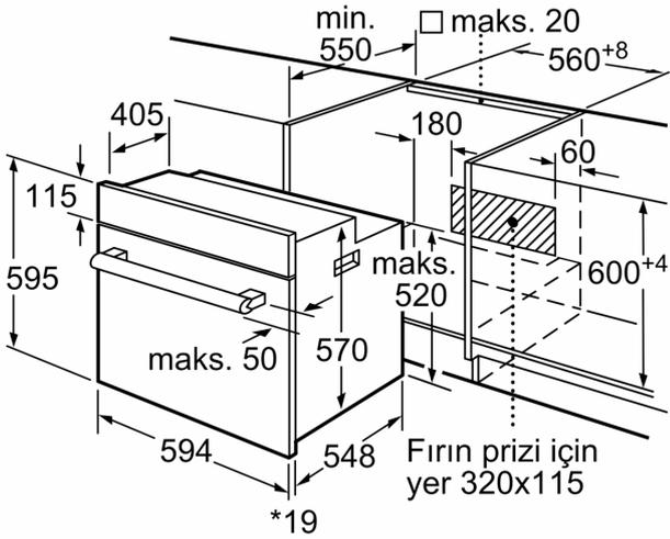
\* Metal ön cephe için 20 mm
