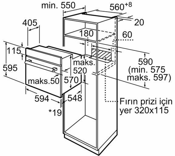
\* Metal ön cephe için 20 mm
