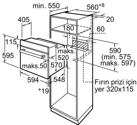
\* Metal ön cephe için 20 mm
