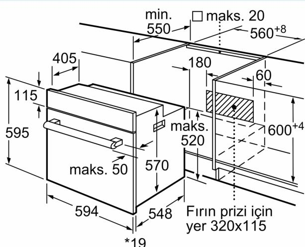
\* Metal ön cephe için 20 mm
