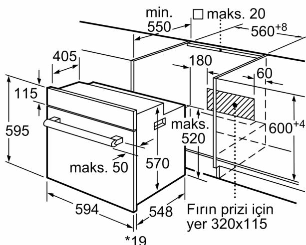
\* Metal ön cephe için 20 mm
