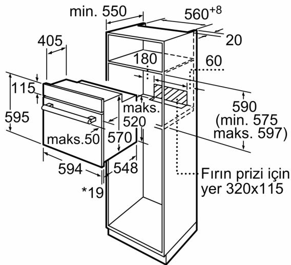
\* Metal ön cephe için 20 mm
