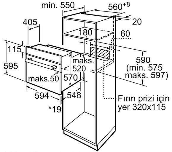
\* Metal ön cephe için 20 mm
