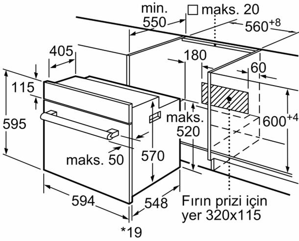
\* Metal ön cephe için 20 mm
