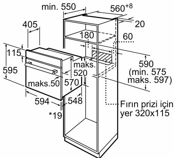
\* Metal ön cephe için 20 mm
