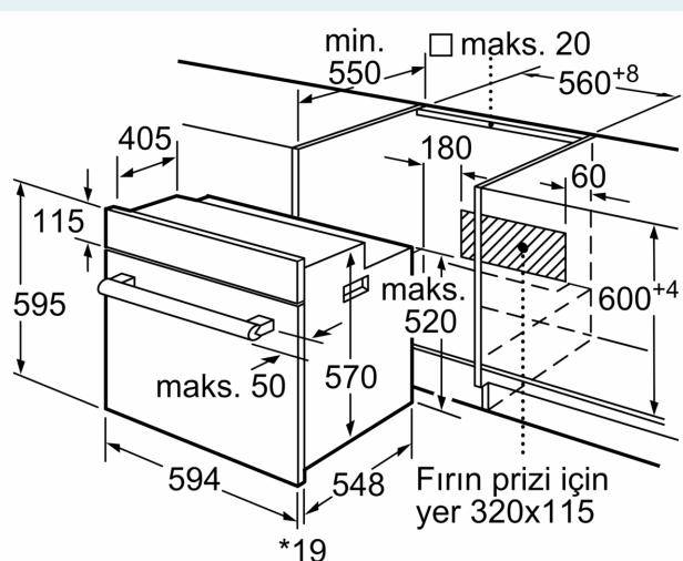
\* Metal ön cephe için 20 mm
