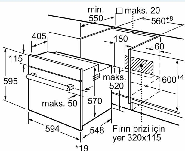
\* Metal ön cephe için 20 mm
