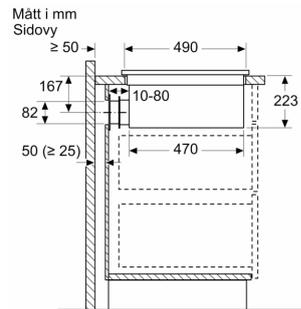
Vid montering direkt mot oisolerad yttenvägg
