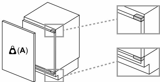
Monterade frontpaneler på enheten som överskrider tillåten vikt kan ge skador och påverka gångjärnsfunktionen
