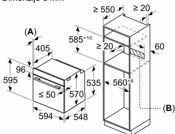
Ugradnja sa pločom za kuvanje.
