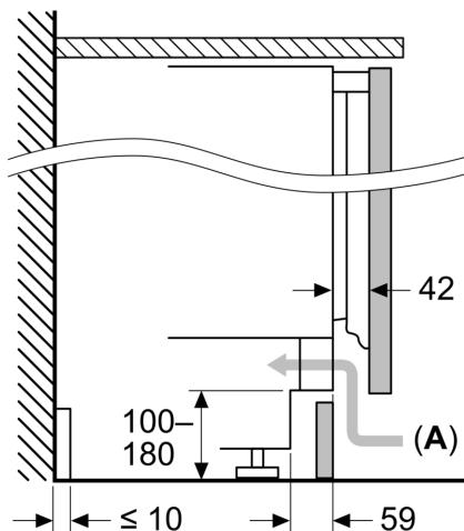
**A: Dovod vazduha  $\geq 200$  cm<sup>2</sup>**
