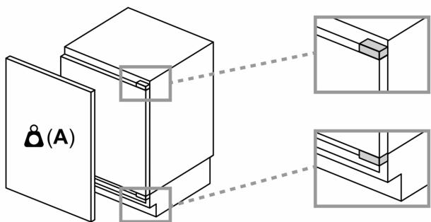
Postavljene prednje strane uređaja koje prekoračuju dozvoljenu težinu mogu da izazovu oštećenje i dovedu do funkcionalnog oštećenja šarki
