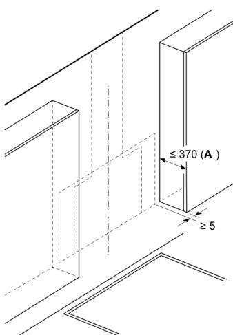
A: Maks. dubina bočnih visokih ormarića (uključujući vrata) za montažu staklene ploče
