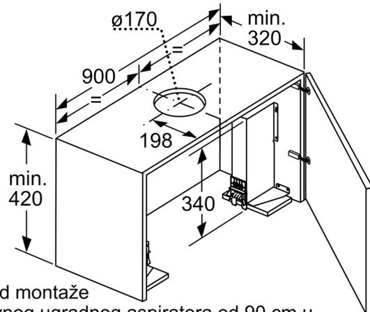
Kod montaže ravnog ugradnog aspiratora od 90 cm u gornji kuhinjski element širine 90 cm potreban je set za montažu. Oba nosača za montažu treba zašrafiti u element nameštaja sa desne i leve strane. Montaža prema šablonu.
