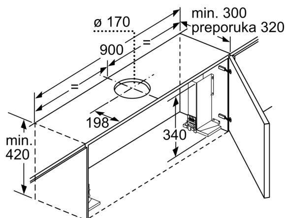
Za montažu ravnog ugradnog aspiratora od 90 cm u gornji kuhinjski element širine 90 cm potreban je set za montažu. Obe montažne ugaone ploče se levo i desno pričvršćuju zavrtnjima u element nameštaja.
