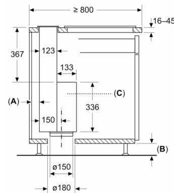
Standardno: sa mostom za radnu ploču između stonog ventilatora i ploče za kuvanje
