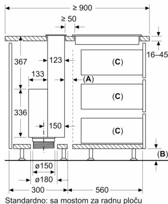
Standardno: sa mostom za radnu ploču između stonog ventilatora i ploče za kuvanje
