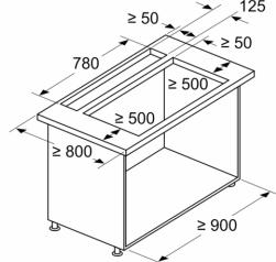
Standardno: sa mostom za radnu ploču između stonog ventilatora i ploče za kuvanje
