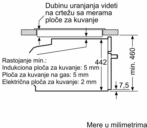
Ako je ispod ploče za kuvanje ugrađen kompaktni uređaj, morate da obratite pažnju na sledeće debljine radne ploče (eventualno uključujući potkonstrukciju).
