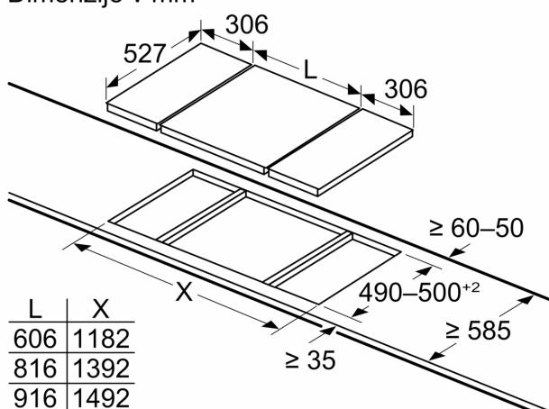
Če montirate dve enoti Domino tik ob kuhalno ploščo, sta potrebna dva montažna kompleta (HEZ394301)
