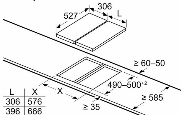
Če sta dva elementa ali več montirana tik drug ob drugem, je potreben en montažni komplet ali več (2 elementa 1 montažni komplet, 3 elementi 2 montažna kompleta itd.)
