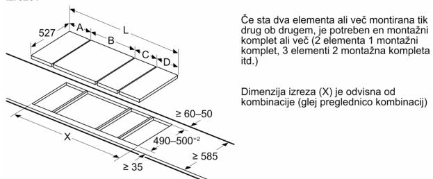
Če sta dva elementa ali več montirana tik drug ob drugem, je potreben en montažni komplet ali več (2 elementa 1 montažni komplet, 3 elementi 2 montažna kompleta itd.)
