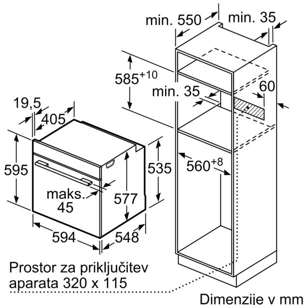
Če se aparat montira pod kuhalilče, je treba upoštevati naslednjo debelino delovne plošče (po potrebi vklj. s podkonstrukcijo).
