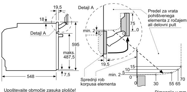
Če se aparat montira pod kuhalisce, je treba upoštevati naslednjo debelino delovne plosche (po potrebi vklj. s podkonstrukcijo).
