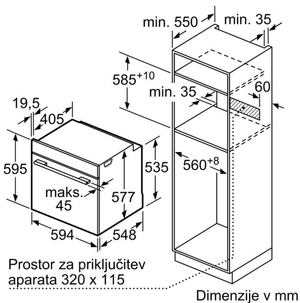
Če se aparat montira pod kuhališče, je treba upoštevati naslednjo debelino delovne plošče (po potrebi vklj. s podkonstrukcijo).
