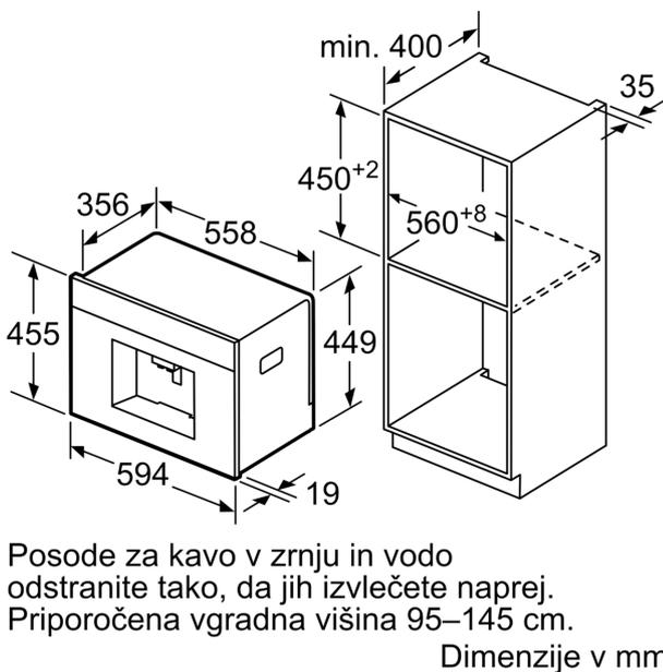
Posode za kavo v zrnju in vodo odstranite tako, da jih izvlečete naprej. Priporočena vgradna višina 95–145 cm.
