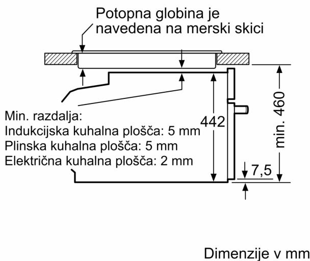
Če se kompaktni aparat montira pod kuhalische, je treba upoštevati naslednjo debelino delovne plošče (po potrebi vklj. s podkonstrukcijo).
