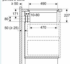
Pri inštalácii priamo oproti vonkajším stenám, ktoré nie sú izolované ( $\mu \geq 0,5 \text{ W/m}^2 \cdot \text{°C}$ ) odporúčame použiť konfiguráciu recirkulácie čiastočne alebo úplne odvádzaného vzduchu.
