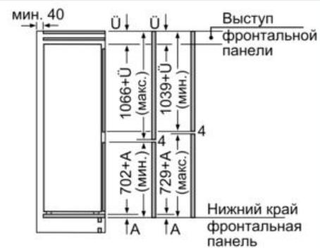
Размеры приведены с учётом зазора между дверцами 4 мм.
