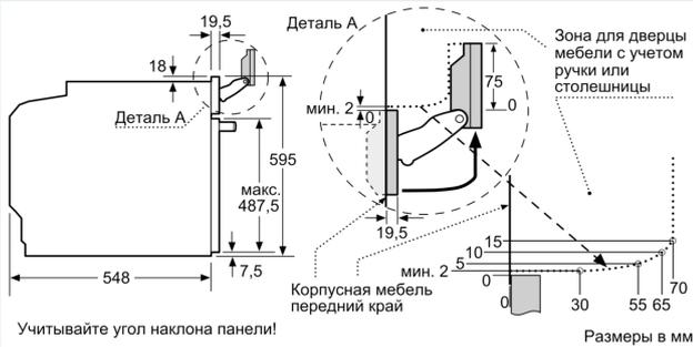
При встраивании прибора под варочную панель необходимо учитывать требования к толщине столешницы (включая усиливающий элемент).
