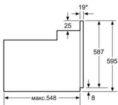
\* При металлической фронтальной панели 20 мм
