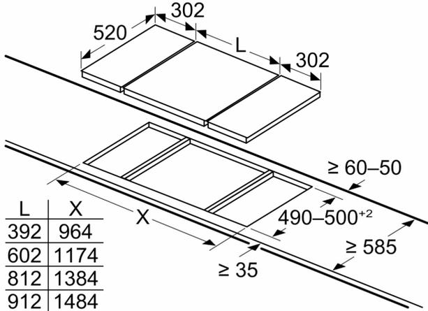
При установке двух приборов Domino рядом с варочной панелью требуется два монтажных комплекта (HZ394301)
