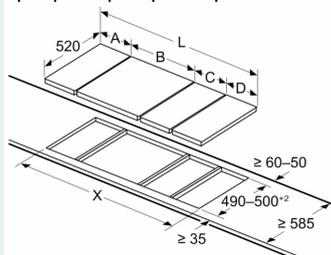
При установке нескольких предметов рядом друг с другом требуется один или несколько монтажных комплектов (2 прибора — 1 монтажный комплект, 3 прибора — 2 монтажных комплекта и т. д.)
