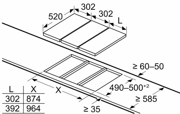
При установке нескольких предметов рядом друг с другом требуется один или несколько монтажных комплектов (2 прибора — 1 монтажный комплект, 3 прибора — 2 монтажных комплекта и т. д.)
