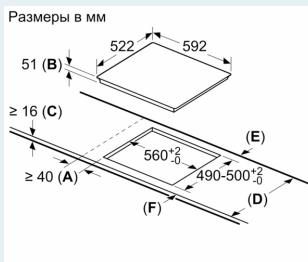
A: Минимальное расстояние от выреза для варочной панели до стены.
