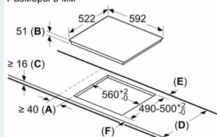
**A:** Минимальное расстояние от выреза для варочной панели до стены.
