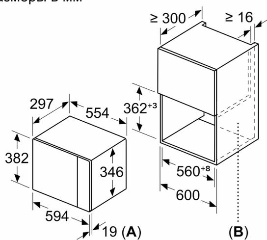
A: 20 мм при металлической фронтальной панели
