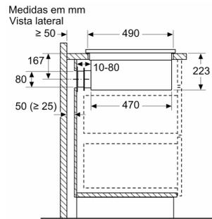
Ao instalar diretamente em paredes exteriores não isoladas ( $\mu \geq 0.5 \text{ W/m}^2 \text{ } ^\circ\text{C}$ ), recomendamos a utilização de configurações de recirculação em conduta parcial ou total.
