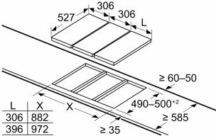
Se dois ou mais elementos forem instalados um ao lado do outro, são necessários um ou vários kits de instalação (2 elementos, 1 kit de instalação; 3 elementos, 2 kits de instalação, etc.)
