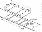
Se dois ou mais elementos forem instalados um ao lado do outro, são necessários um ou vários kits de instalação (2 elementos, 1 kit de instalação; 3 elementos, 2 kits de instalação, etc.)
