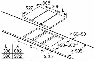
Se dois ou mais elementos forem instalados um ao lado do outro, são necessários um ou vários kits de instalação (2 elementos, 1 kit de instalação; 3 elementos, 2 kits de instalação, etc.)
