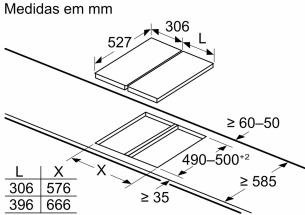
Se dois ou mais elementos forem instalados um ao lado do outro, são necessários um ou vários kits de instalação (2 elementos, 1 kit de instalação; 3 elementos, 2 kits de instalação, etc.)
