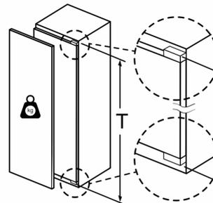
Portas do móvel montadas, que excedam o peso permitido, podem originar danos e falhas de funcionamento na dobradiça.
