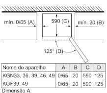
nos modelos com puxadores integrados na vertical, é necessária uma distância mínima de 65 mm para uma abertura simples. Medidas em mm
