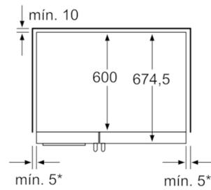
\* Se o aparelho for colocado junto a um fogão, a distância lateral não pode ser inferior a 30 mm.
