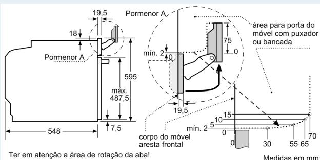
Se o aparelho for instalado por baixo de uma placa de cozinhar, tem de ser observada a seguinte espessura da bancada (se necessário incl. estrutura inferior).
