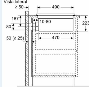
Ao instalar diretamente em paredes exteriores não isoladas ( $\mu \geq 0.5 \text{ W/m}^2 \text{ } ^\circ\text{C}$ ), recomendamos a utilização de configurações de recirculação em conduta parcial ou total.
