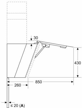
**A: Espessura máx. parede traseira**
