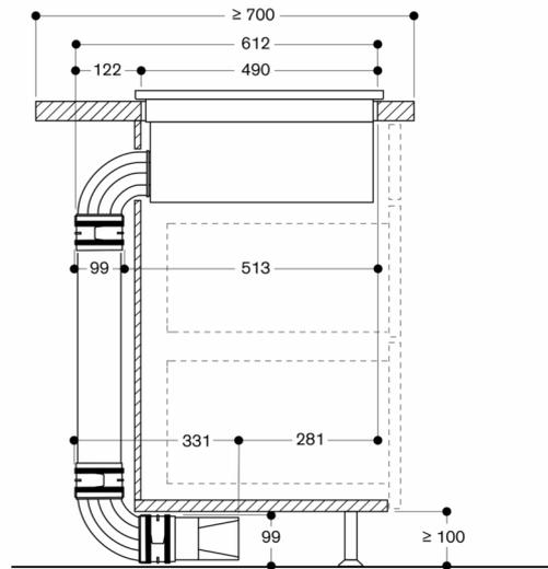
Não recomendado para parede exterior ou piso sem isolamento térmico ( $U \geq 0,5 \text{ W/m}^2\text{K}$ )
