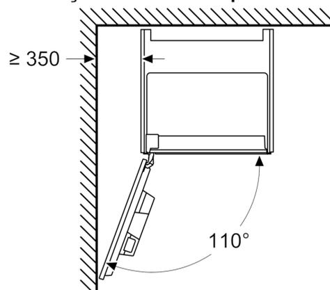
Se se utilizar o limitador de dobradiça de 92°, a distância mín. à parede é de apenas 100 mm
