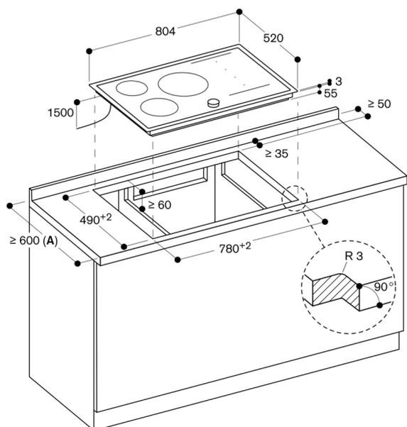
A: Verifique no manual de instalação se a profundidade da bancada é inferior a 600 mm.
