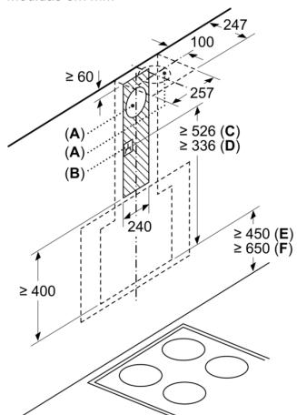
**A:** Saída de extração de ar**B:** Tomada**C:** Conjunto de recirculação do ar Clean Air Plus**D:** Extração ou conjunto de recirculação do ar standard
