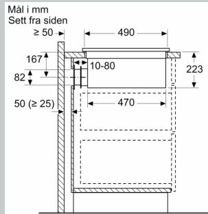
Ved installasjon helt inntil yttervegg uten isolasjon ( $\mu \geq 0.5 \text{ W/m}^2\text{C}$ ) anbefaler vi konfigurasjoner med delvis eller fullstendig avtrekk i kanal.
