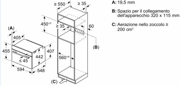
Montaggio di due apparecchi sovrapposti
