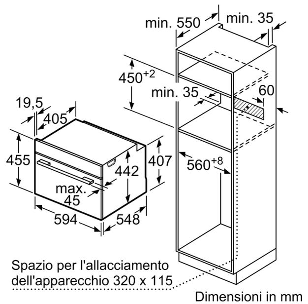
**Montaggio con un piano di cottura.**
