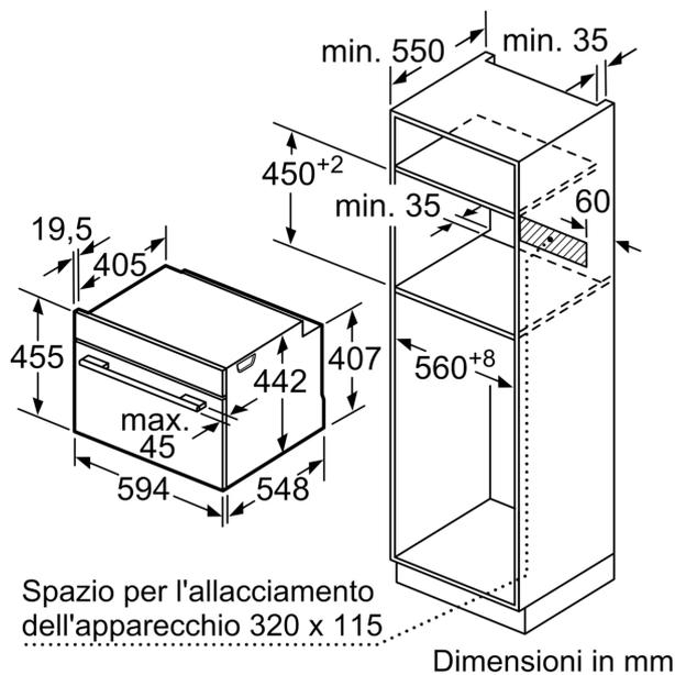
Montaggio con un piano di cottura.
